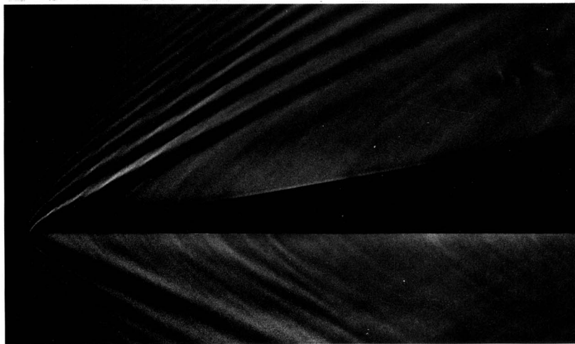
229. Гидравлическая аналогия обтекания клина сверхзвуковым потоком. Однородный слой воды глубиной 5 мм течет со сверхкритической скоростью по горизонтальной плоскости и отклоняется заостренным клином с углом при вершине 10^\circ и с нижней гранью, параллельной потоку. Гравита-
