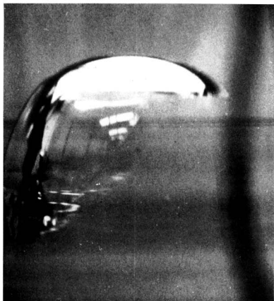
185. Пузырь со сферической головкой и «вобкам». Пузыри, содержащие 50–100 см 3 воздуха, поднимаются в минеральном масле. При скоростях, больших примерно 40 см/с, и вязкости, превы-
