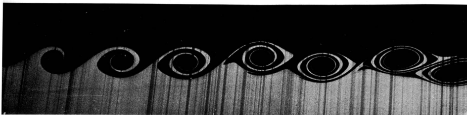
145. Неустойчивость Кельвина–Гельмгольца в стратифицированном сдвиговом течении. Длинная труба прямоугольного сечения, первоначально горизонтальная, заполнена водой поверх окрашенного соляного раствора. Примерно в течение часа происходит свободная диффузия жидкостей, а затем труба внезапно наклоняется на угол 6^\circ , приводя в движение обе жидкости. Соляной раствор
