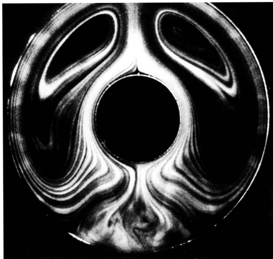
208. Линии тока в конвективном движении между соосными цилиндрами. Дым от сигареты демонстрирует структуру вполне развитого ламинарного течения в воздухе при атмосферном давлении. Диаметр внешнего цилиндра в три раза больше диаметра внутреннего, причем внешний цилиндр холоднее внутреннего на 14,5^{\circ}\text{C} , что дает число Грасгофа, рассчитанное по ширине зазора, равное 120000. [Grigull, Hauf, 1966]
