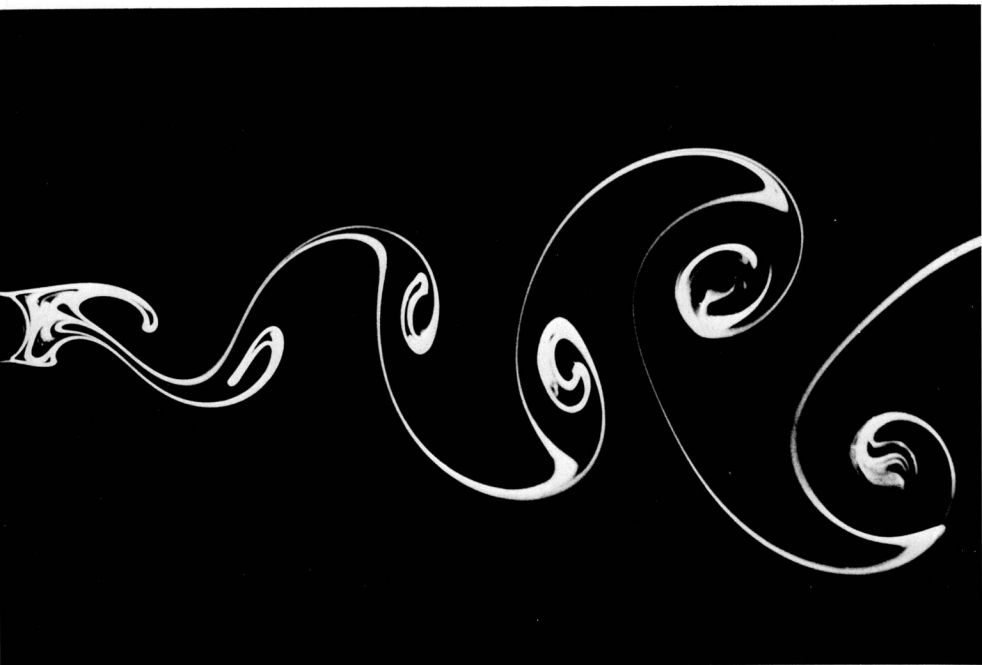
94. Вихревая дорожка Кармана за круговым цилиндром при Re = 140 . Вода обтекает цилиндр диаметром 1 см со скоростью 1,4 см/с. Визуализация движения осуществляется так: частицы метаются белым коллоидным дымом, создаваемым элек-
