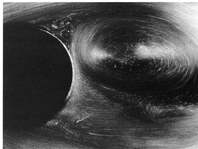
62. Внезапное начало движения кругового цилиндра при Re = 1700 , Ut/d = 4,05 . На этой более поздней стадии движения след уже потерял свою первоначальную симметричную форму и начинает ронять вихри в поток. [Honji, Taneda, 1969]
