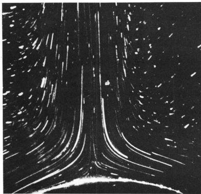
206. Свободная конвекция от горизонтального цилиндра. Круговой цилиндр диаметром 6 см и длиной 60 см равномерно нагрет до температуры, превышающей температуру окружающего воздуха на 9^{\circ}\text{C} , что дает число Грасгофа, равное 30 000. Интерферограмма демонстрирует тепловые пограничные слои, сливающиеся сверху и создающие стационарный ламинарный факел, аналогичный показанному на фото 203. Фото U. Griggull, W. Hauf
