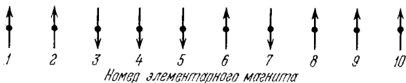
Рис. 2.1. Модельная система из элементарных магнитов, расположенных в фиксированных точках вдоль одной прямой, с магнитными моментами, равными +\mu и -\mu .
