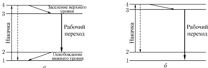
Рис. 93. а — Схема четырехуровневой системы с рабочим переходом между уровнями 3 \rightarrow 2 (оптические лазеры); б — генерация колебаний с частотой, превосходящей частоту накачки (квантовые генераторы радиодиапазона).
