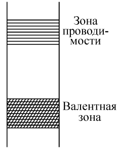
Рис. 125. Расположение энергетических зон у изолятора.
