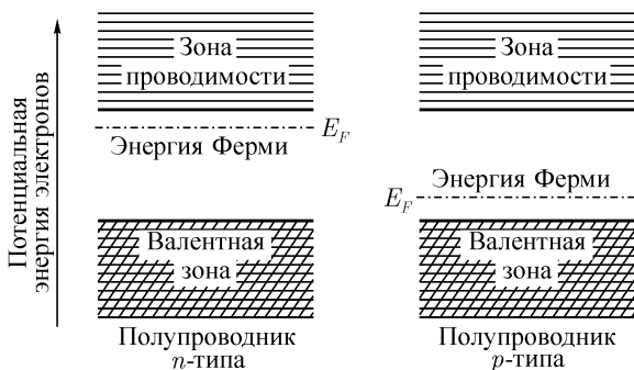
Рис. 138. Положение зон и энергий Ферми в полупроводниках n - и p -типа (до соприкосновения).
