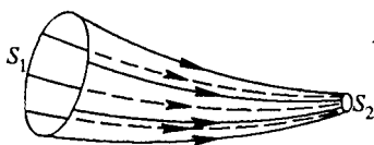
Рис. 217. Трубка тока движущейся жидкости
