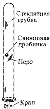
Рис. 42. Падение разных предметов в трубке, из которой выкачан воздух
