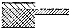
Рис. 9.3. Распределение электронов по энергетическим уровням в случае перекрытия свободной и заполненной зон.
