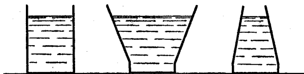
Рис. 13.3. Силы давления жидкости на дно сосудов одинаковы во всех трех случаях.
