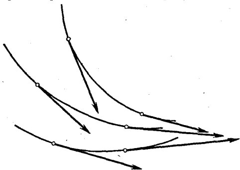
Рис. 14.1. Скорости частиц движущейся жидкости и линии тока.
