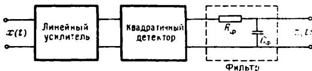
Р и с. 7.5. Схема варианта практической реализации инерционного преобразователя
