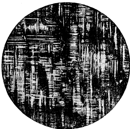
Фиг. 598. Решетчатое строение микроклина под микроскопом при скрещенных николях. \times 45
