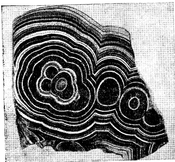
Фиг. 374. Концентрически-зональное строение малахита (полированная поверхность). Гумешевское месторождение на Урале
