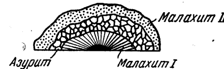
Фиг. 378. Разрез почки состоящей из малахита I (в центре) радиально-лучистого строения, азурита и малахита II, образовавшегося в результате изменения азурита с поверхности. По Ф. В. Чухрову
