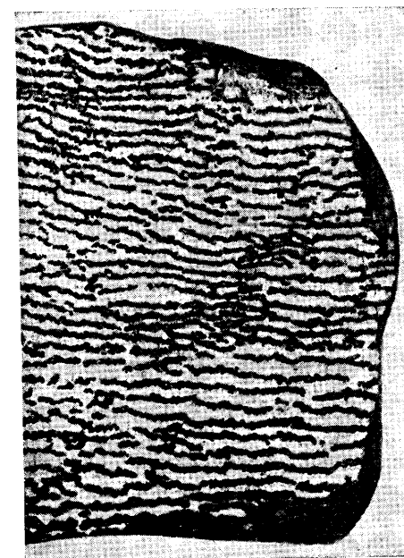
Фиг. 78. «Бурундучная руда». Каданское месторождение (Забайкалье). Темные полосы — сфалерит ( \text{ZnS} ); светлые — карбонат (анкерит)
