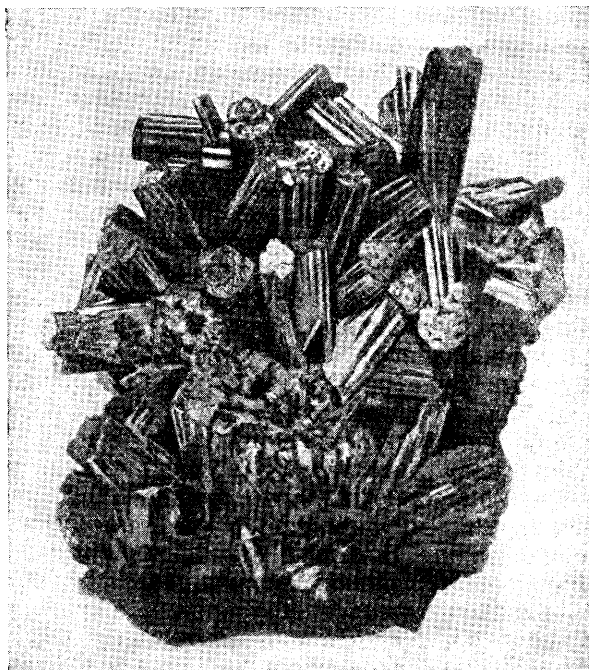
Фиг. 335. Друза кристаллов манганита. Ильфельд (Гарц, Германия)
