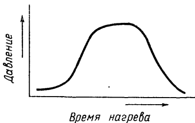
Рис. 48. График изменения давления пара внутри сырья в процессе ВЧ-сушки.
