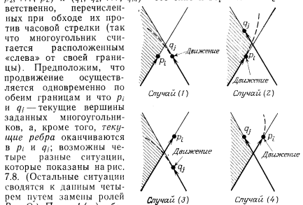
Рис. 7.8. Иллюстрация механизма продвижения. Мы продвигаемся по одной или по другой границе в зависимости от относительного расположения текущих вершин p_i и q_j (текущие ребра показаны жирными прямыми).
