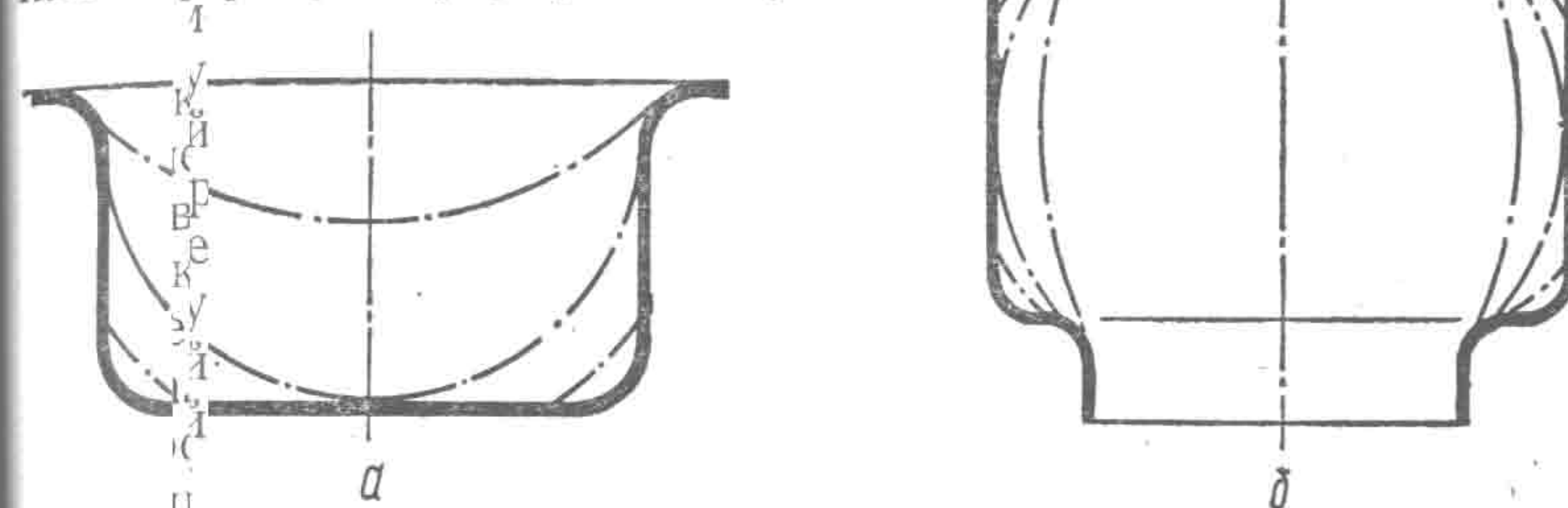
Рис. 23. Изменение формы заготовки в процессе ЭГ деформирования: а — вытяжка; б — раздача.
