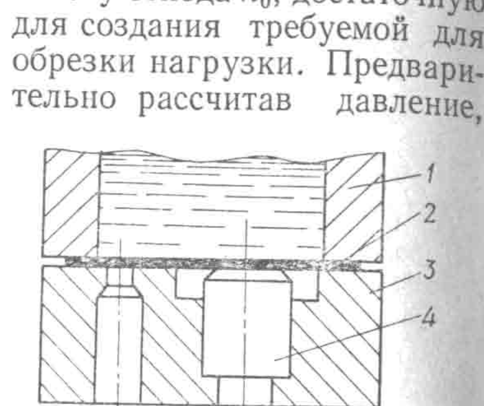
Рис. 93. Схема оснастки для пробивки отверстий разных диаметров: 1 — камера; 2 — заготовка; 3 — матрица; 4 — подпор.
