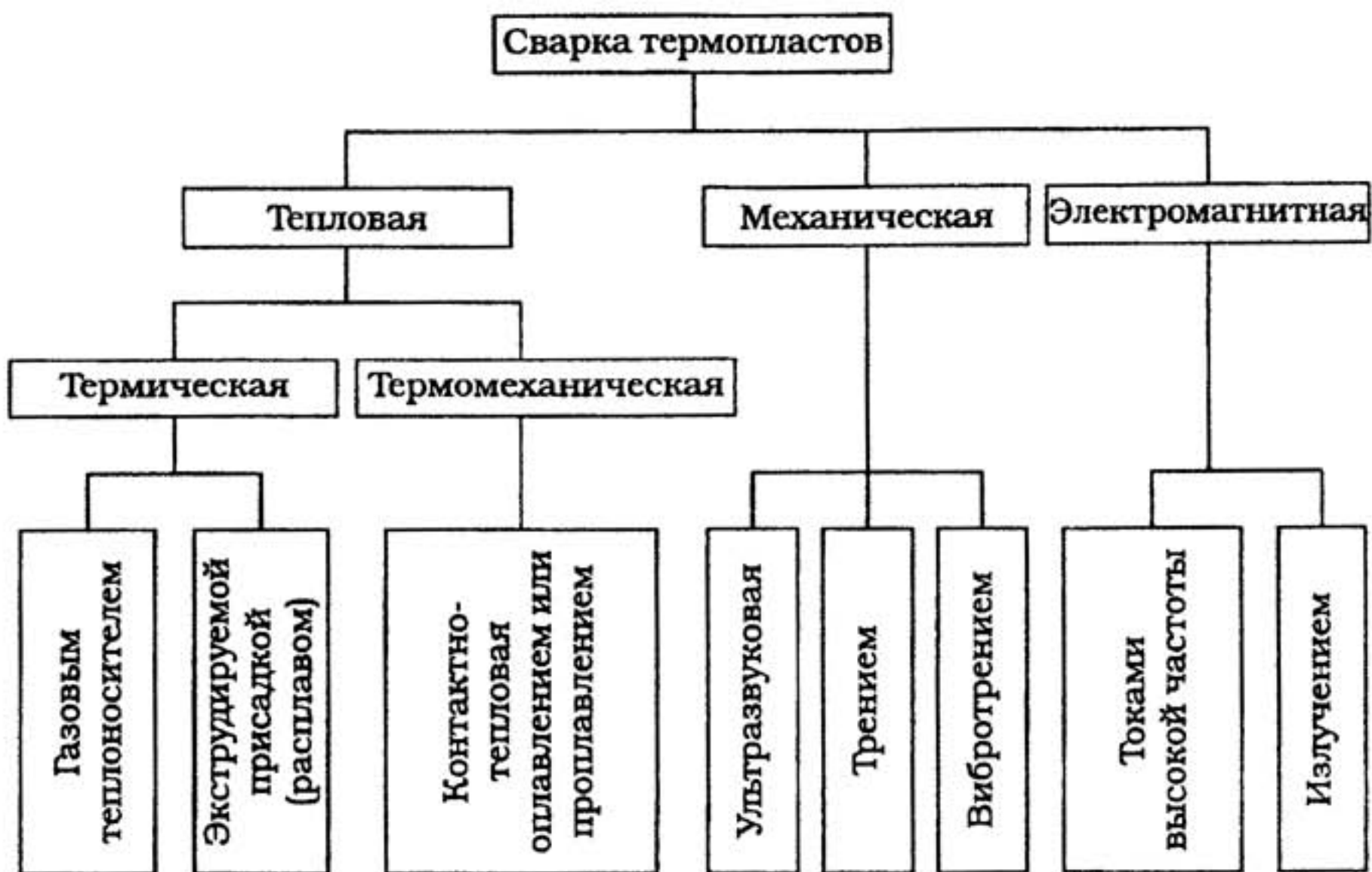
Рис. 5.18. Классификация способов сварки термопластов
