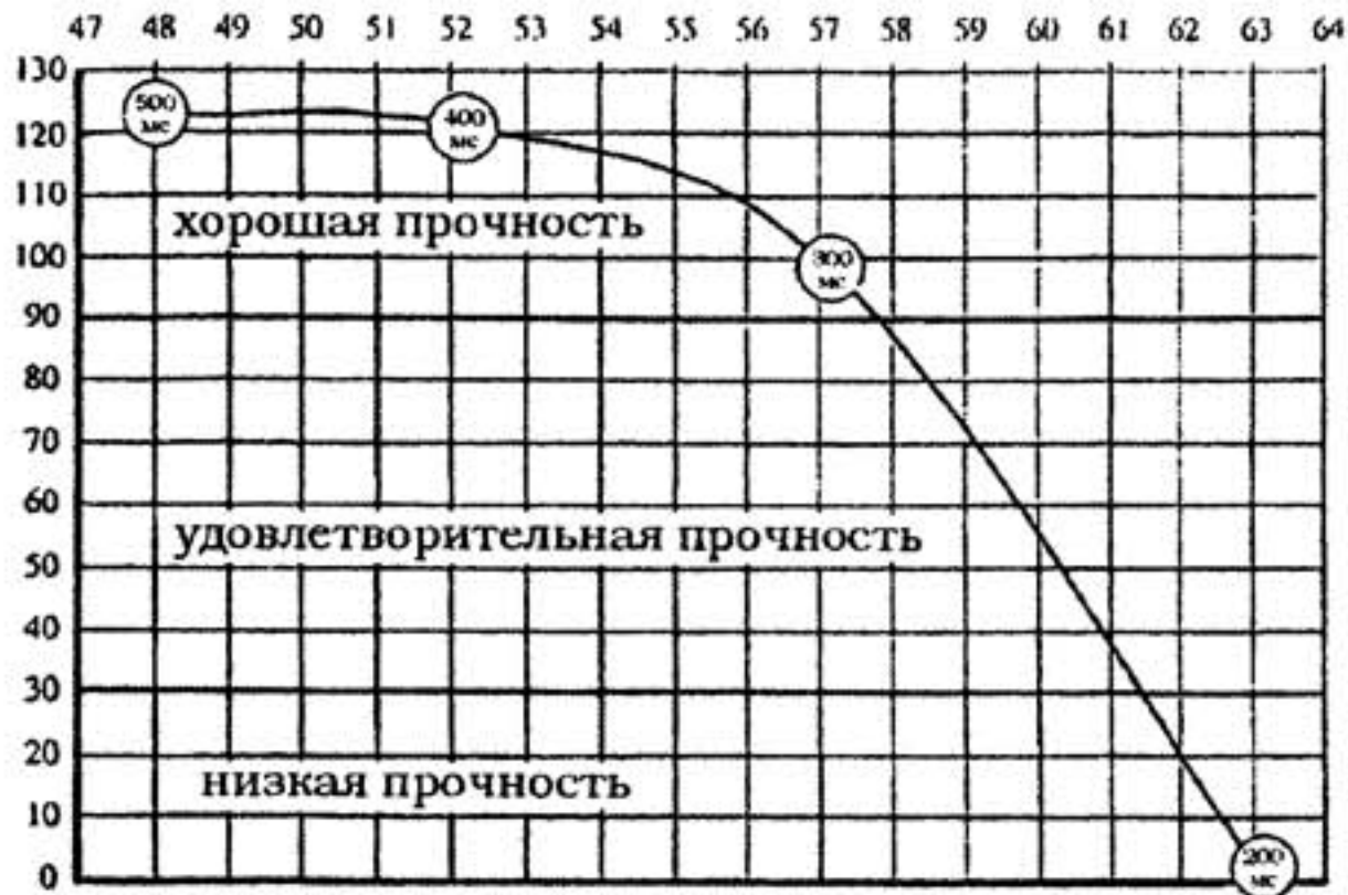
Рис. 5.42. Зависимость результатов испытаний мягкой тары из ПЭНД на разрушение от технологических режимов ее изготовления
