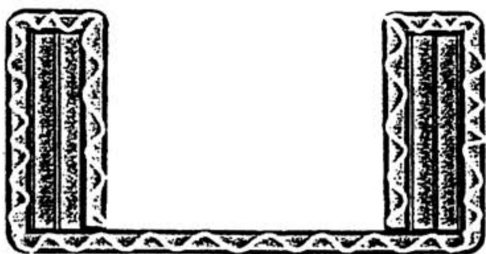
Рис. 6.35. Жесткий вкладыш в транспортные ящики. Места перегиба гофрокартона на 180^\circ бигуются с помощью матриц с двумя параллельными каналами или с широким каналом
