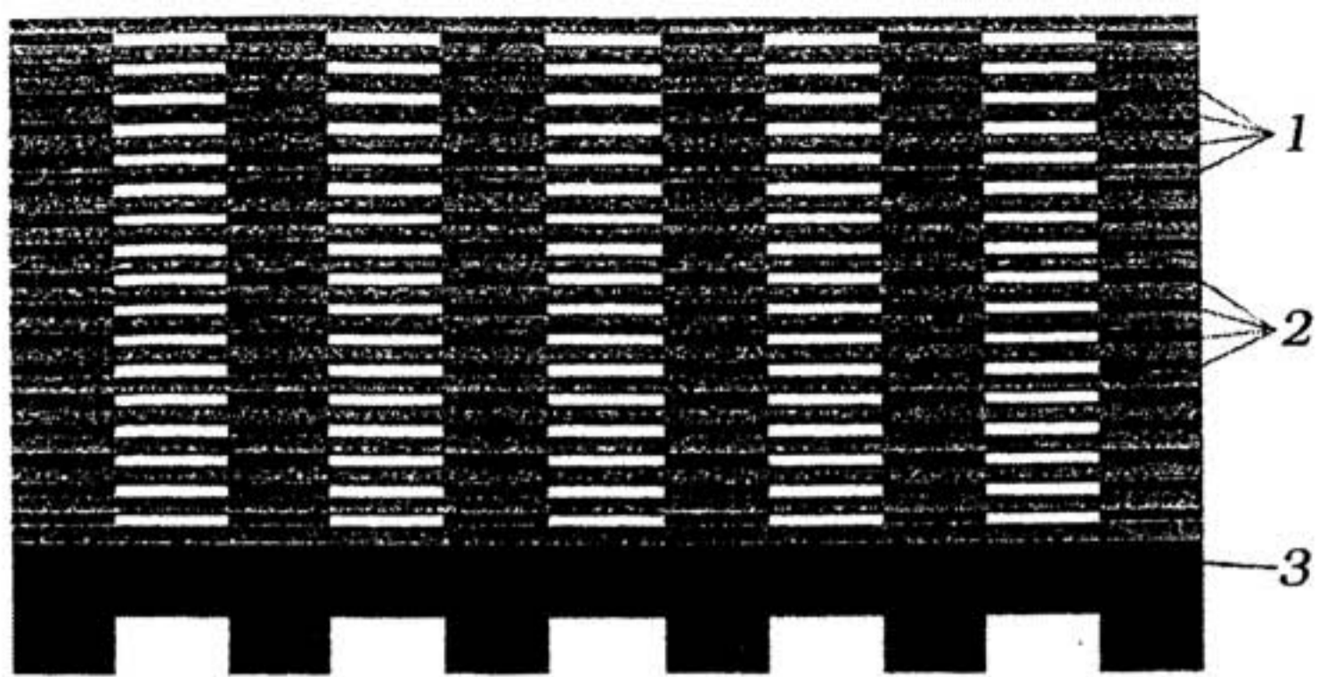
Рис. 6.39. Схема укладки фанеры для естественной сушки: 1 — фанера; 2 — калиброванные прокладки; 3 — палета
