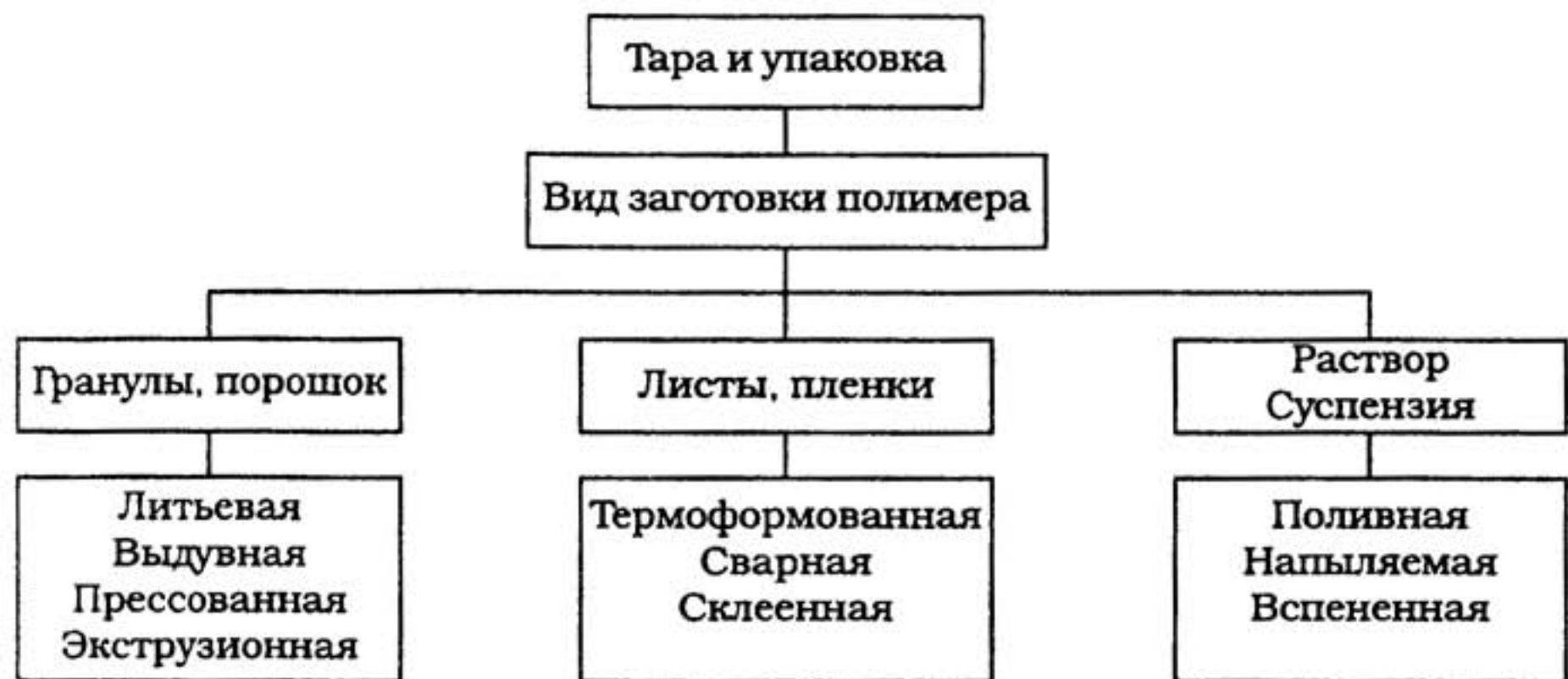
Рис. 2.17. Классификация тары и упаковки из полимеров по технологии производства
