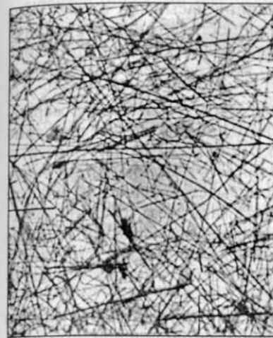
Рис. 7.4. Электронно-микроскопические фотографии кристаллов пальгорскита (по Л. Г. Рекшинской)
