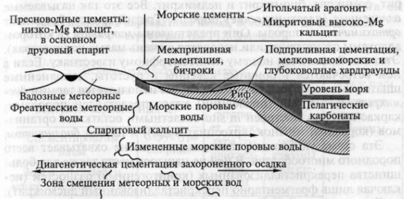
Рис. 8.8. Основные обстановки цементации карбонатных осадков (по Prothero, Shwab, 1996)
