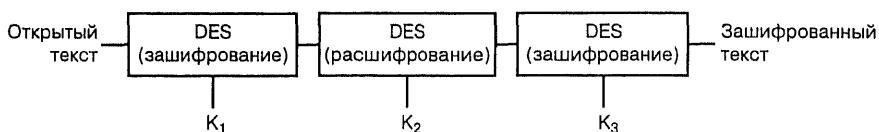
Рис. 1.12. Схема Triple DES
