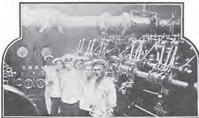
Машинное помѣщеніе „Ардагана“. (2 двигателя по 500 д. л. с. и 2—по 80 д. л. с.).
