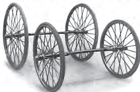
Скаты осей на шарикахъ съ металлическими колесами и резиновыми шинами.
