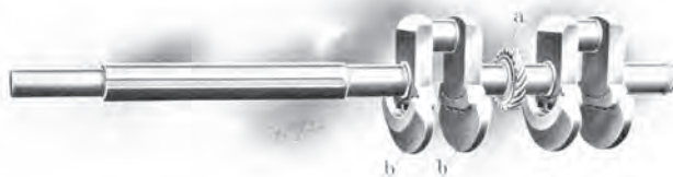
Колѣнчатый валъ двухцилиндроваго двигателя Дизеля. а—винтовая шестерня; b,b—противовѣсы.
