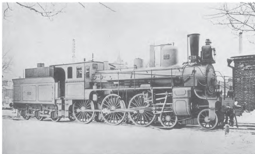
Типъ № 68. Пассажирскій паровозъ „Компаундъ“ типа Владикавказской ж. д.
