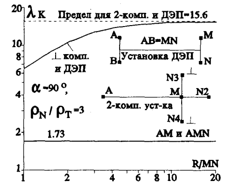
Рис.5.1.4. Зависимости \lambda_k для AM, ДЭП и T-установки от R/MN
