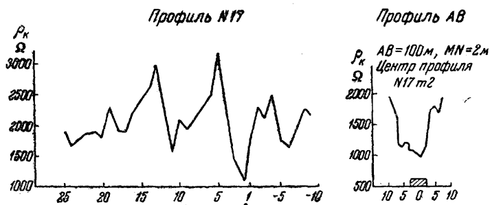
Рис. 175. Результаты электрического профилирования над кварцевой маломощной жилой (по А. М. Загармистру, 1937) На графиках представлена кривая \rho_k ; цифры на оси абсцисс — точки профиля; заштриховано рудное тело
