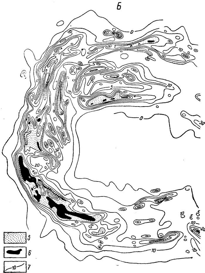
Рис. 200 Б. Результаты магниторазведки на том же магнитном месторождении (рис. 200 А) 5 — площади со значениями Z_a от 50 до 100 тыс. гамм; 6 — площади со значениями Z_a более 100 тыс. гамм; 7 — изолинии положительных значений Z_a (через 0,01 эрстед)
