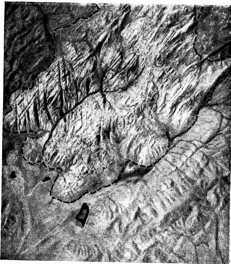
Рис. 39. Аэрофотоснимок незалесенной местности в масштабе 1 : 20 000—1 : 22 000. Гранитный массив (обведен пунктиром) резкими формами рельефа отчетливо выделяется среди более сглаженных вмещающих песчаников и сланцев
