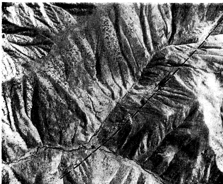
Рис. 55. Дизъюнктивное нарушение в толще массивных пород. Рядом с разрывом проведена пунктирная линия. Аэрофотоснимок в масштабе примерно 1 : 17 000
