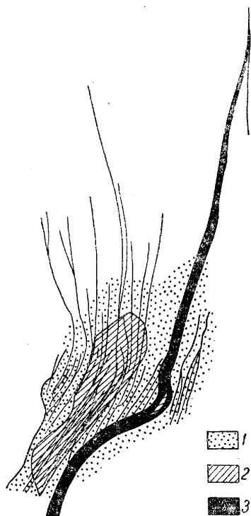
Рис. 3. Морфология одной из типичных рудных зон Южного участка 1 — бедные рудные участки; 2 — более богатые участки руды; 3 — наиболее богатые участки руды
