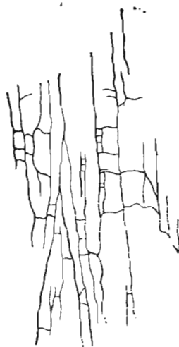
Рис. 229. Фрагмент кливажной ящичной текстуры лимонита по галениту. Увел. 6
