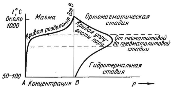
Рис. 57. Диаграмма температуры и состава (слева) и температуры и давления (справа) для систем летучего компонента А (воды) и нелетучего компонента В (силикатов). По П. Ниггли
