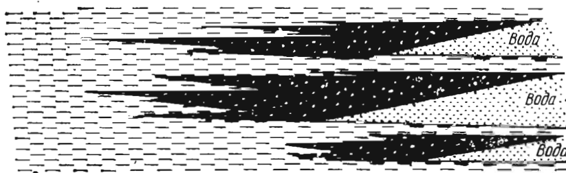
Рис. 19. Линзовидные залежи нефти или газа в пластах выклинивающихся песков среди сланцев. По И. Броду.
