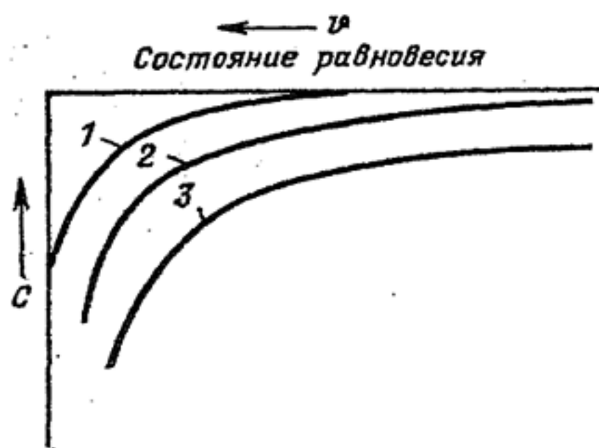
Рис. 15.3. Схема изменения степени насыщения подземных вод различными соединениями с в зависимости от скорости их движения
