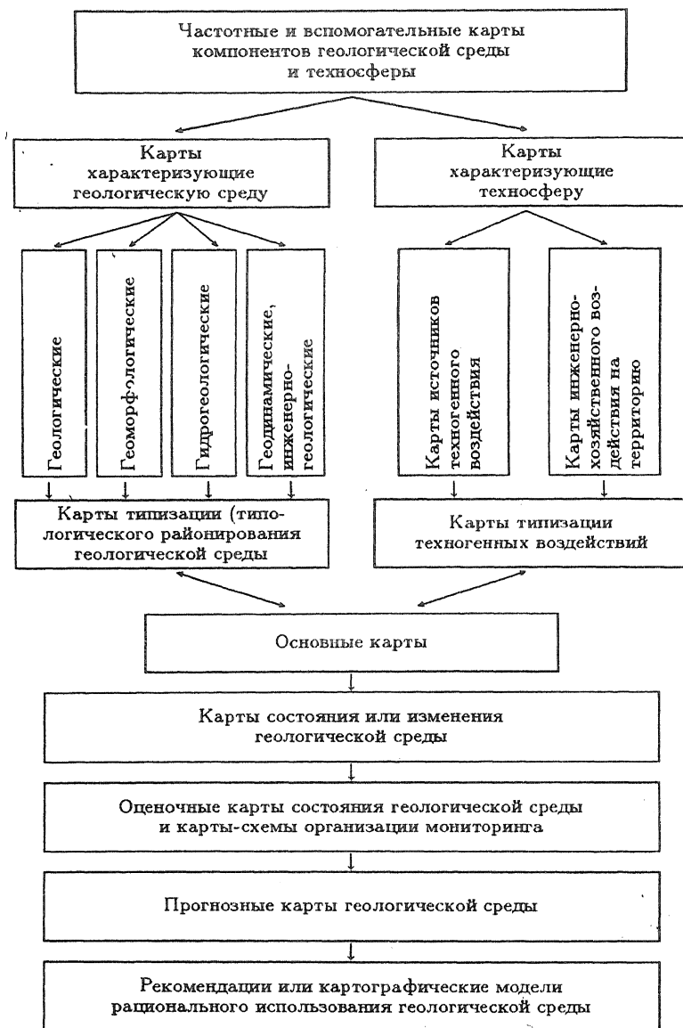
Рис. 23. Схема последовательности составления картографических моделей геологической среды и организации мониторинга
