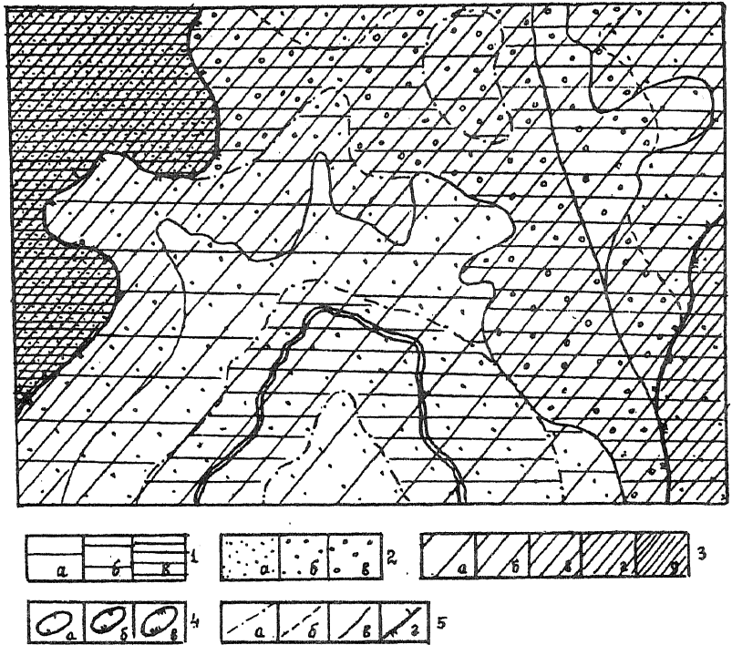
Рис. 24. Фрагмент карты прогнозной реакции территории на техногенное загрязнение: 1 — расчлененность рельефа очень способствующая выносу (а), способствующая (б), не способствующая выносу загрязнений (в); 2 — накопление загрязнений биомассой растительности: а — слабое, б — умеренное, в — сильное; 3 — накопление загрязнений породами зоны аэрации: а — очень слабое, б — слабое, в — умеренное, г — сильное, д — очень сильное; 4 — вынос загрязнений подземными водами: а — слабый, б — умеренный, в — сильный; 5 — границы районов с различными значениями расчлененности рельефа (а), биомассы (б), емкости обмена пород (в) и водопроницаемости пород (г)
