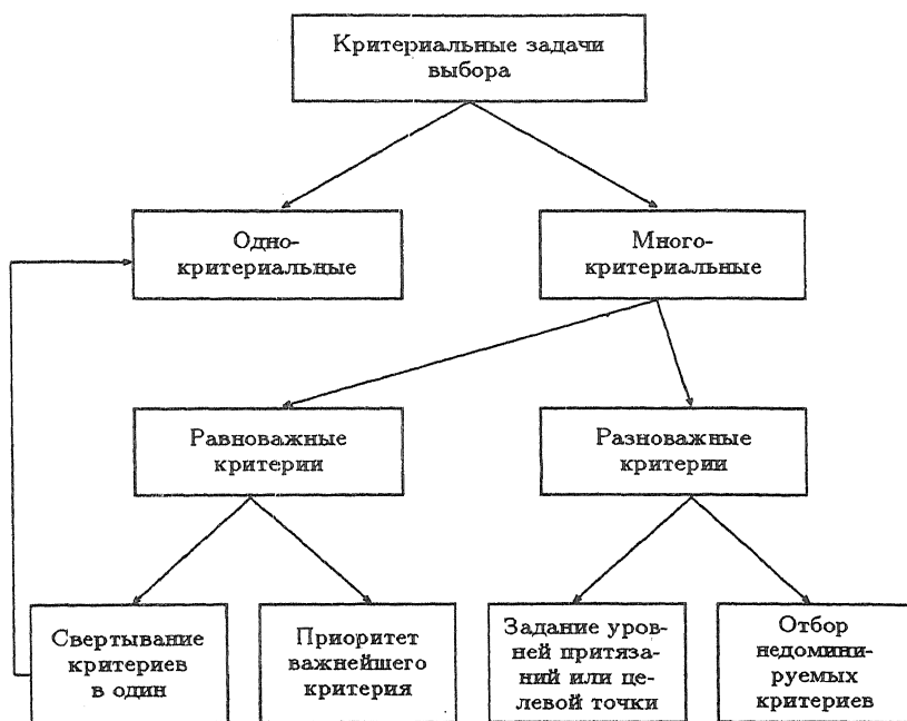
Рис. 37. Классификация задач выбора и способов их решения в системе мониторинга геологической среды (по Ф.И. Перегудову и Ф.П. Тарасенко, 1989)
