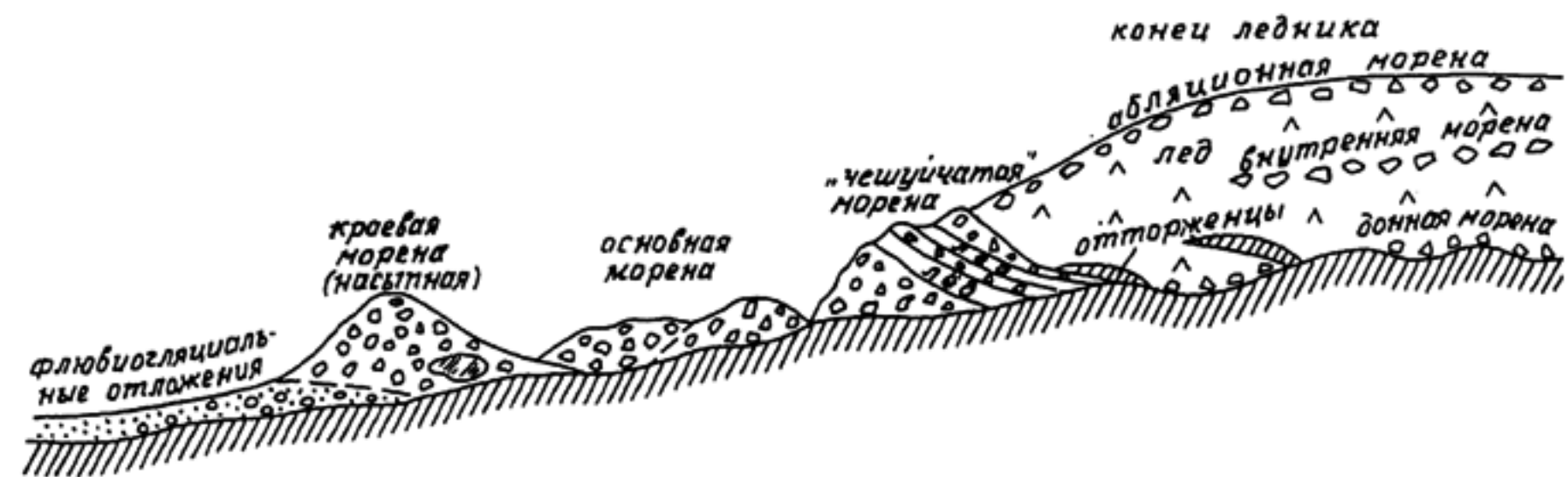
Рис. 29. Схема положения моренного материала относительно ледника (по Ю.А.Лаврушину)
