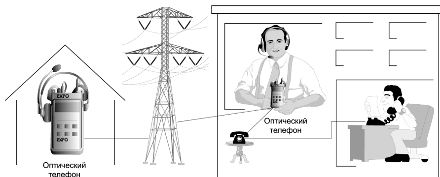
Рис. 9.1 Оптический телефон позволяет поддерживать связь по тестируемому кабелю обслуживающему персоналу
