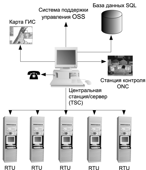
Рис. 9.18 Структура системы дистанционного тестирования волокон RFTS
