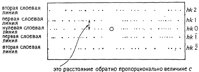
Рис. 5.32. Типичная рентгенограмма качания. Предполагается, что ось кристалла c^* вертикальная. Другие детали рентгенограммы не приведены, так как для промера и расшифровки фотопленки необходимо использовать специальные графики.
