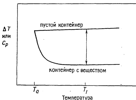
Рис. 4.10. Схематическое изображение кривых, получаемых при измерении теплоемкости вещества при температуре T_1 , которая намного выше начальной температуры эксперимента T_0 .
