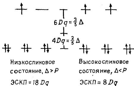
Рис. 8.10. Низкоспиновое и высокоспиновое состояния d 7 -ионов в октаэдрическом поле лигандов.
