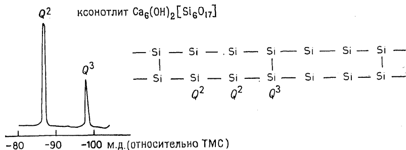
Рис. 3.14. Спектр ЯМР ^{29}\text{Si} ксеноотлита [18]. Схематически в виде двойной цепи анионов (упрощенно обозначенных химическим знаком кремния) приведена также структура этого силиката кальция; атомам кремния приписаны соответствующие значения Q .
