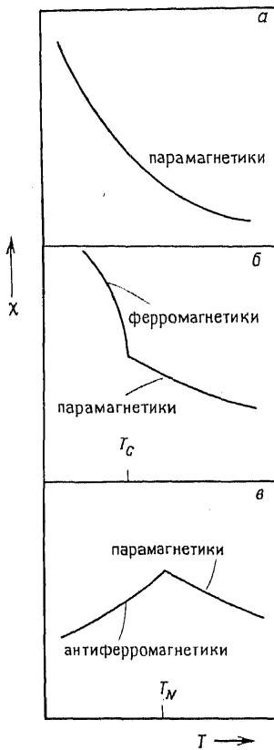
Рис. 16.3. Температурная зависимость магнитной восприимчивости парамагнитных (а), ферромагнитных (б) и антиферромагнитных (в) веществ.
