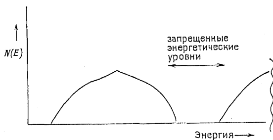
Рис. 14.7. Плотность состояний согласно зонной теории.
