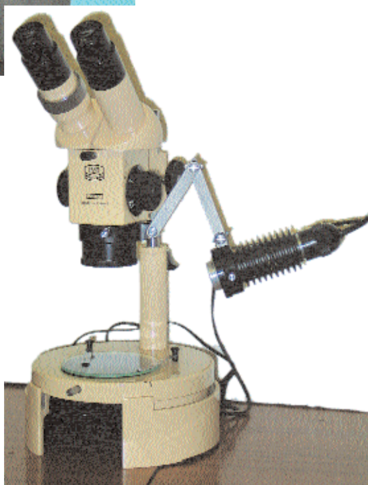
Рис 9. МСТ-2 (стереомікроскоп для мікропрепарування та спостереження об'єктів у прохідному та відбитому світлі).
