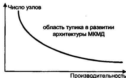
Рис. В-2. К иллюстрации ограничения развития МКМД-архитектуры при увеличении числа узлов и производительности узлов
