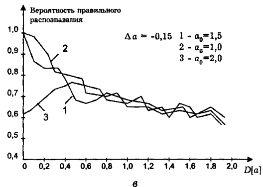
Рис. 15.4. Усредненные кривые зависимости вероятности правильного распознавания от дисперсии весовых коэффициентов для трех реализаций одного нейрона: а - при \Delta a = 0 ; б - при \Delta a = 0,15 ; в - при \Delta a = -0,15
