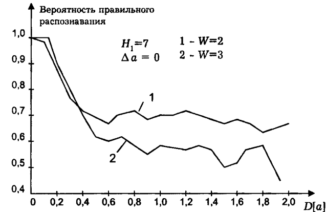
Рис. 15.11. Усредненные кривые зависимости вероятности правильного распознавания от дисперсии весовых коэффициентов для двухслойной и трехслойной сети с одинаковым числом нейронов в первом слое ( H_1=7 )
