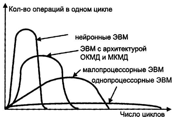
Рис. В-4. Иллюстрация качественных возможностей распараллеливания, представляемых вычислительными средствами различного класса
