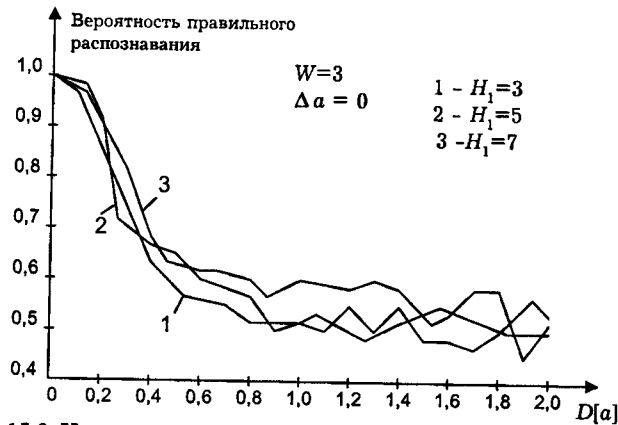
Рис. 15.8. Усредненные кривые зависимости вероятности правильного распознавания от дисперсии весовых коэффициентов для трехслойных сетей с различным числом нейронов в первом слое
