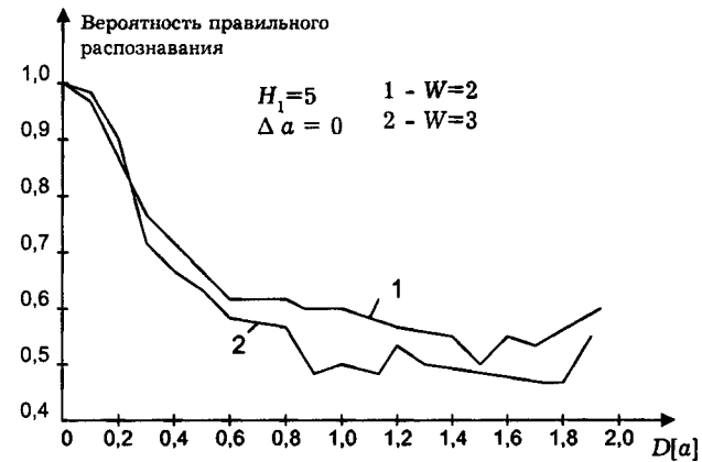
Рис. 15.10. Усредненные кривые зависимости вероятности правильного распознавания от дисперсии весовых коэффициентов для двухслойной и трехслойной сети с одинаковым числом нейронов в первом слое ( H_1=5 )
