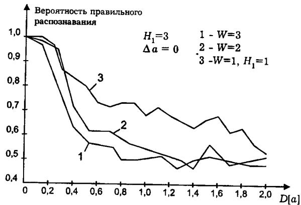
Рис. 15.9. Усредненные кривые зависимости вероятности правильного распознавания от дисперсии весовых коэффициентов для нейронов двухслойной и трехслойной сети, реализующих одинаковую логическую функцию
