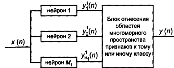
Рис. 2.6. Структурная схема нейронной сети, реализующей кусочно-линейную разделяющую поверхность
