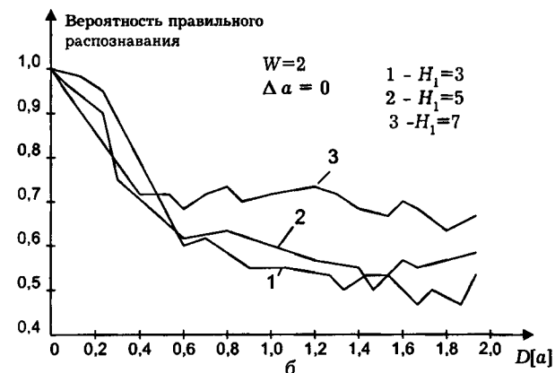
Рис. 15.7. Усредненные кривые зависимости вероятности правильного распознавания от дисперсии весовых коэффициентов для двухслойных сетей с различным числом нейронов в первом слое
