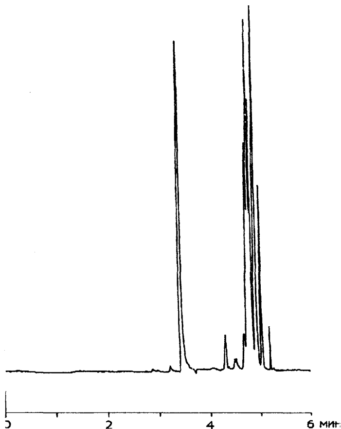
Рис. 79. Разделение смеси 11 ФМОК-аминокислот методом КЗЭ. Капилляр: 50мкм x 50/75 см, буфер: бора в 50 мМ, рН 9.5; УФ-детектирование 200 нм; поле 330 В/см.
