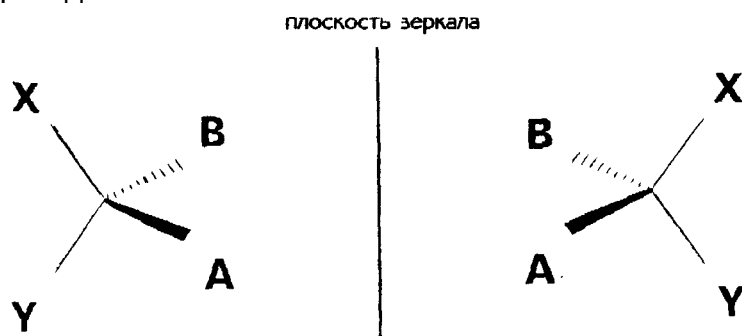
Рис. 83. Схемы замещения на центре хиральности. А, В, X, Y: различные замещения на одном центре хиральности (асимметричный атом углерода).
