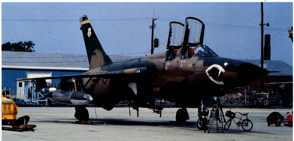
Вверху: фотография сделана в 1981 году — к тому времени F-105G находились на вооружении только 128-й тактической истребительной эскадрильи (тиаэ). На подкрыльевых пилонах подвешены учебные УР AGM-45 Shrike. В конце 1981 — начале 1982 года появилась модификация F-105, который мог нести на центральном узле PPP Standard.
