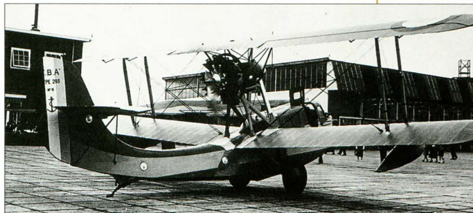
Самолеты семейства Type 290 представляли собой одностоечные бипланы с размахом верхнего крыла меньшим, чем у нижнего. На фотографии — вариант Type 293.
