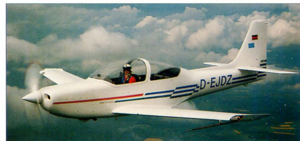
Созданный на базе Bravo, самолет Eurotrainer был рассчитан на четырех человек, оснащался убираемым шасси и двигателем Lycoming или Porsche, и был полностью приспособлен к полетам по приборам.
