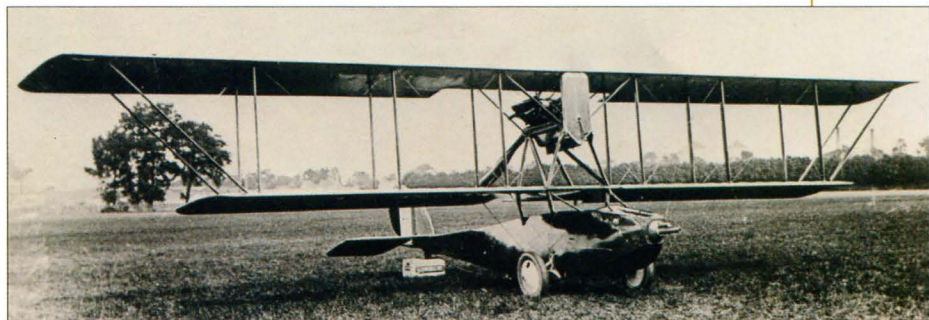
Одноместная летающая лодка Type D — это модифицированный вариант модели Type C с пушкой, имевший тот же корпус-лодку, но оснащенный обычным колесным шасси. Построен лишь один самолет, поднявшийся в воздух в 1916 году.
