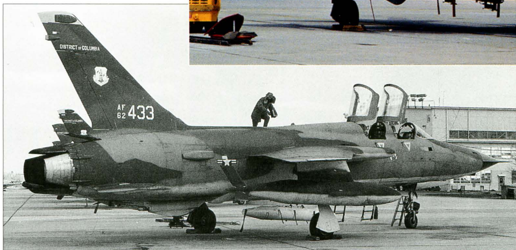
Вверху: фотография сделана в 1981 году — к тому времени F-105G находились на вооружении только 128-й тактической истребительной эскадрильи (тиаэ). На подкрыльевых пилонах подвешены учебные УР AGM-45 Shrike. В конце 1981 — начале 1982 года появилась модификация F-105, который мог нести на центральном узле PPP Standard.
